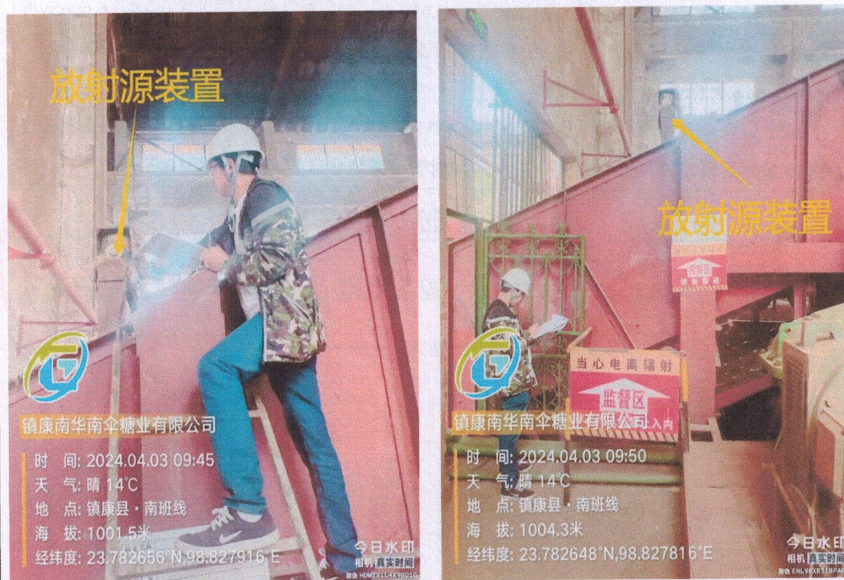
图4 镇康南华南伞糖业有限公司压榨车间在用放射源装置现场照片
