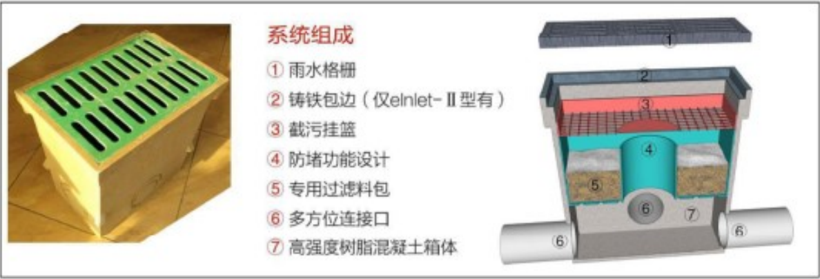
图 6-11 截污式雨水口构造图
