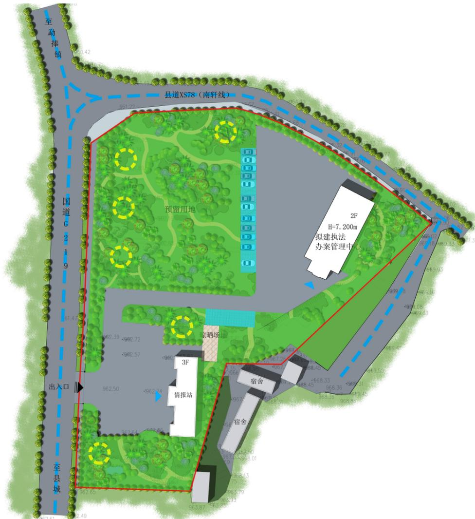
下沉式绿地是低于周围地面的绿地，其利用开放空间承接和贮存雨水，达到减少径流外排的作用，内部植物多以本土草本植物为主。下沉式绿地具有狭义和广义之分，狭义的下沉式绿地指低于周边铺砌地面或道路在 200 mm 以内的绿地；广义的下沉式绿地泛指具有一定的调蓄容积(在以径流总量控制为目标进行目标分解或设计计算时，不包括调节容积)，且可用于调蓄和净化径流雨水的绿地，包括生物滞留设施、渗透塘、湿塘、雨水湿地、调节塘等。
